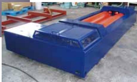
一軸動力吸収部空冷タイプ
