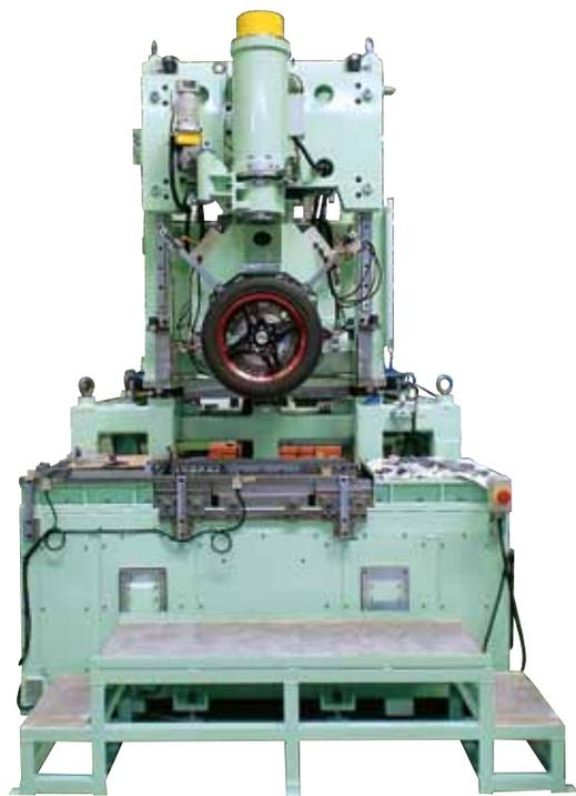
本装置はPCタイヤ及びバイクタイヤの静特性試験、緩和長試験を行うことを目的として設計された装置です。静特性試験は専用定盤を使用して、縦／横／前後／振じりの各剛性試験を行います。
