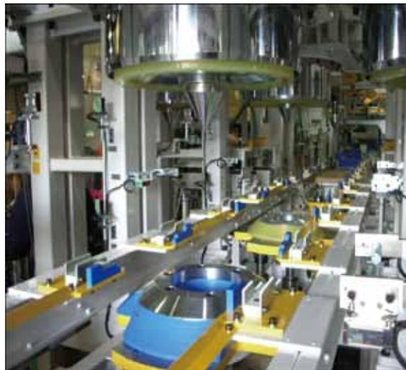
組付けたタイヤにエアを充填するインフレーター
