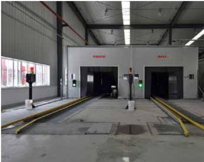
工場で完成された車両は、エンドユーザーへ納める際にPDI (Pre=前、Derivery=納車、Inspection=整備)センターにて納車前整備を実施します。
