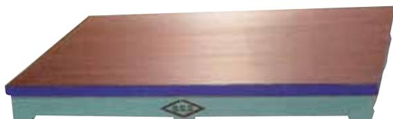
一般修理工場において仕上げ用として用いられる定盤で表面および側面には完全なシカル盤体を施してあります。(へール仕上げ)
